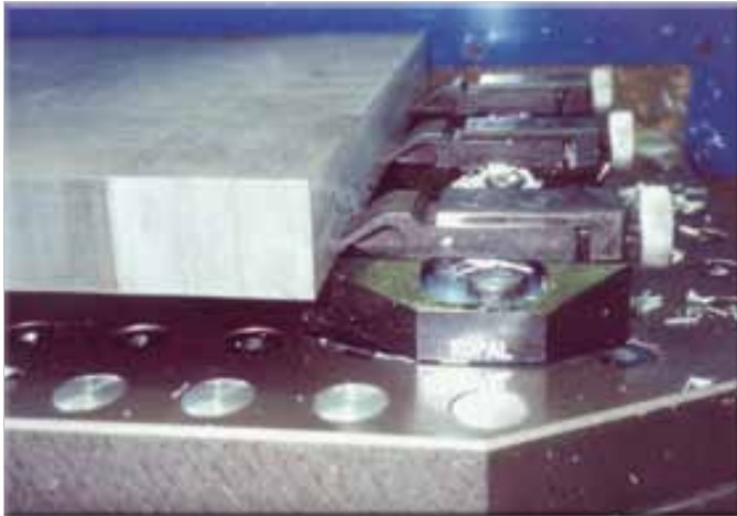
Usinage de plateau en aluminium avec des Mini-poussoirs sur supports spéciaux
