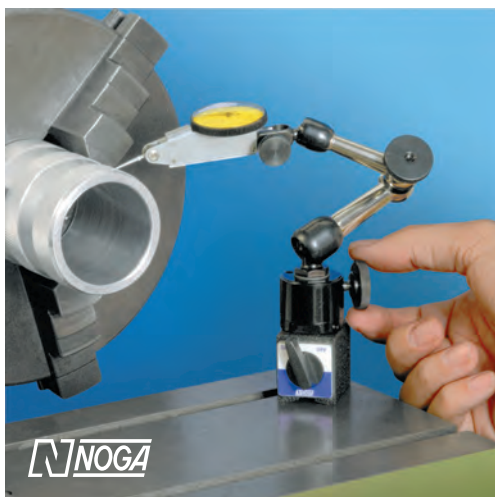
Promo-Kits : support avec réglage fin 3D sur la base + comparateur avec palpeur orientable.
